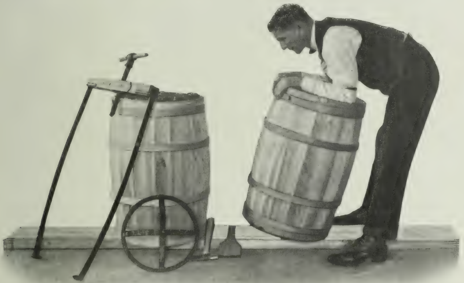
FIG. 5.—TASSEMENT.—A remarquer le madrier de 2 pouces d'épaisseur par 10 pouces de large et la façon dont on s'y prend pour tasser le baril.
